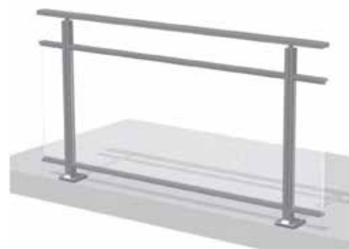
Banda filante con perfil intermedio y relleno de vidrio
