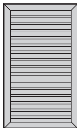
Lame rectangulaire inclinée à 42° pour une occultation partielle
