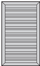
Lame en Y inversé pour une occultation totale
