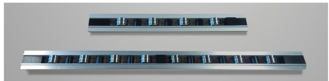
Cada hoja se desliza apoyada sobre dos carros de ruedas como el de la fotografía. Cada carro lleva 4 ruedas dobles de acero inoxidable calidad marina que deslizan sobre un doble raíl de acero inoxidable soportando 500 kg de peso con un mínimo esfuerzo de empuje. Se puede llegar a 1200 kg utilizando el rodamiento de 8 ruedas. Para pesos >500 kg es recomendable motorizar las hojas.
