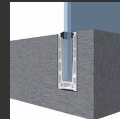
Zócalo en U embudido en el forjado
