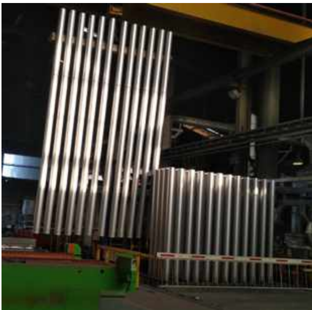
Sortie des billettes en aluminium recyclé Hydro CIRCAL® 75R de la fosse. Longueur de chaque billette : 7 m © Hydro Clervaux
