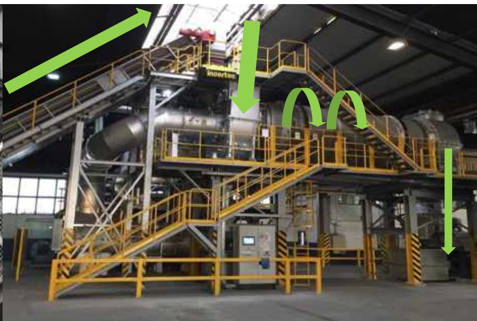
Délaquage effectué dans un four tourneur à pyrolyse. © Hydro
