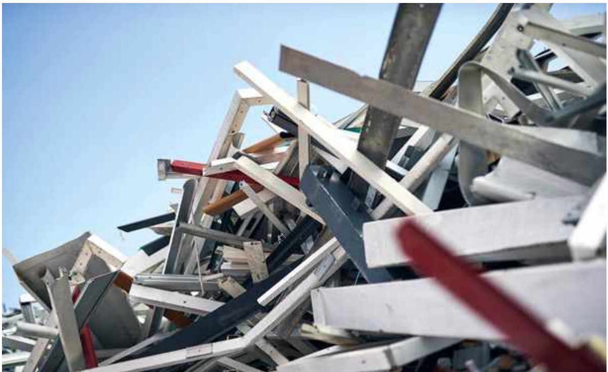
Profils aluminium issus de la déconstruction récupérés par l'usine Hydro de Dormagen, Allemagne. Crédit photo Hydro / SAPA / TECHNAL / WICONA
