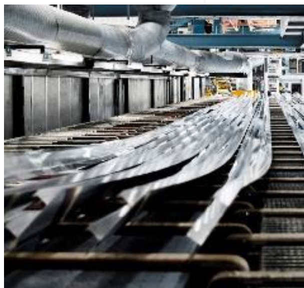
Sortie des profilés de la presse d'extrusion - Crédit photo TECHNAL
